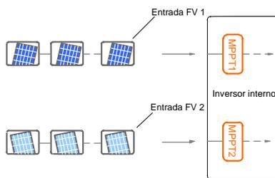
**Fig. 5-4** Modo independente para inversores-D exceto SG8K3-D
