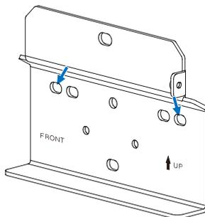
2. Afaste o suporte de montagem em parede e fure nas marcações. A profundidade dos furos deve ser de cerca de 70 mm.
