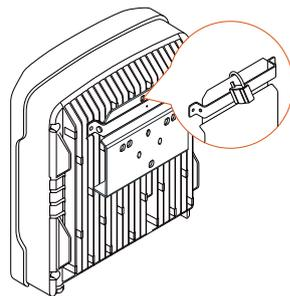
5. Retire a tampa à prova d'água do terminal RS485 e instale o módulo de comunicação no inversor. A figura a seguir usa o módulo Wifi como exemplo. Consulte o manual entregue com o módulo para conhecer mais detalhes.
