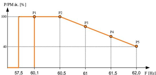
**Fig. 2-7** Curva de redução da potência para Sobrefrequência
