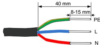
3. Insira totalmente os condutores no terminal correspondente e aperte os parafusos com torque de 0,8 N·m. Puxe os cabos para fora para verificar se estão firmemente instalados.
