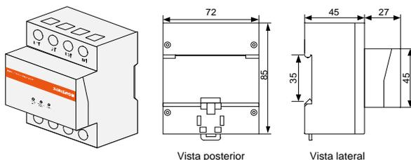
**Fig. 2-5** Dimensões do medidor trifásico (unidade: mm)
