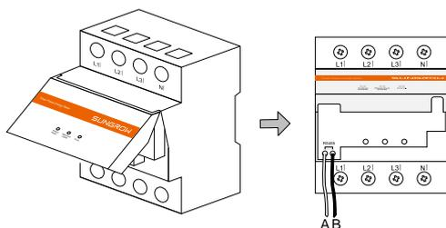
4. Retire 10 mm do isolamento dos fios de alimentação. Em seguida, conecte os fios aos terminais no medidor de energia, conforme exibido abaixo. (Transversal: 10 mm<sup>2</sup> a 25 mm<sup>2</sup>)
