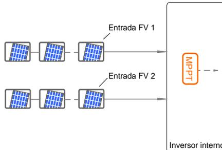
**Fig. 5-6** Modo paralelo para inversores -D exceto SG8K3-D
