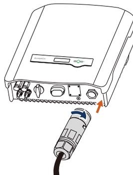
4. Conecte as outras extremidades. Conecte o conector "PE" ao barramento de aterramento. Conecte os condutores "L" e "N" ao disjuntor CA.
