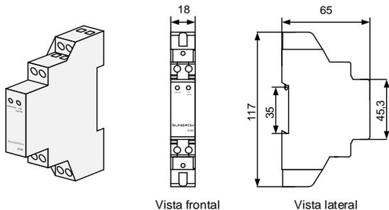
**Fig. 2-4** Dimensões do medidor monofásico (unidade: mm)
