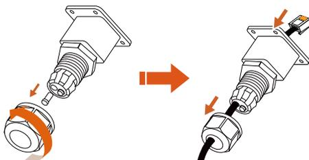
3. Conecte os cabos ao medidor.
