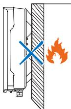
Materiais inflamáveis ou gases próximos à instalação
