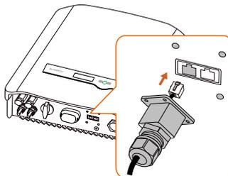
3. Prenda a tampa à prova d'água à parte inferior do inversor com quatro parafusos e arruelas e, em seguida, aperte o prensa-cabos.
