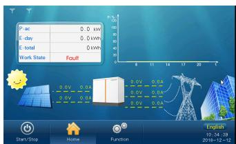
Se existir uma falha, “Work State” apresentará “Fault”. Toque na célula “Fault”.
