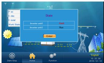
A coluna do estado da unidade do módulo que tem uma falha apresenta “Fault”. Como mostrado na figura à esquerda, ocorre uma falha na unidade do inversor 1. Toque na célula da falha da unidade do inversor 1 para verificar a falha atual.
