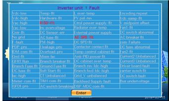
A interface de falha da unidade de inversor 1 aparecerá com o item de falha a vermelho.
